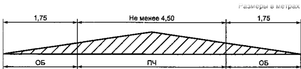
Рис. Поперечный профиль автомобильных дорог категории V ПЧ — проезжая часть, ОБ — обочина.
